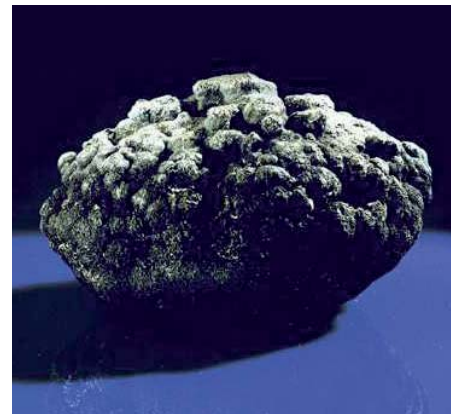
Der Anteil an Buntmetallen wie Kobalt, Kupfer und Nickel macht den Abbau der Manganknollen wirtschaftlich attraktiv
