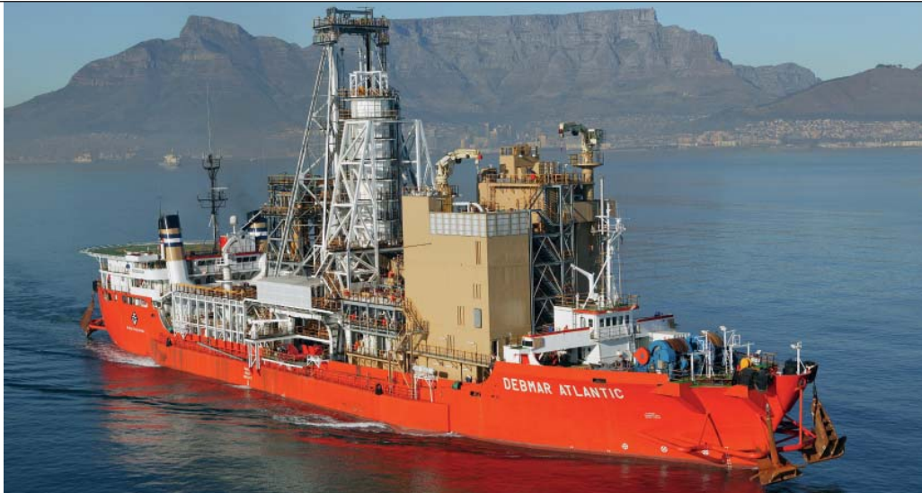
„Debmar Atlantic“ – ein speziell für den Diamantenabbau konzipiertes Schiff
