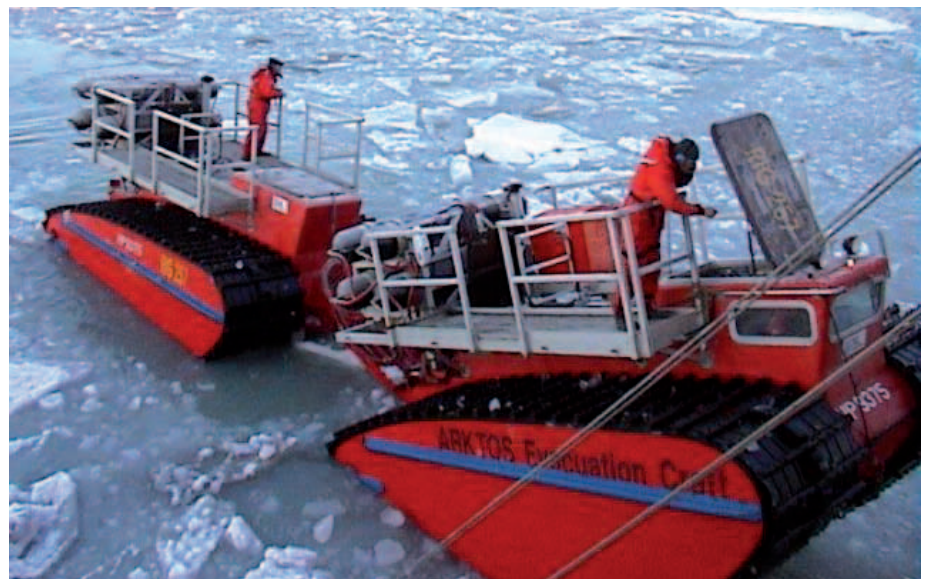
Abb. 2: Arktos-Amphibienfahrzeug als Rettungsfahrzeug
