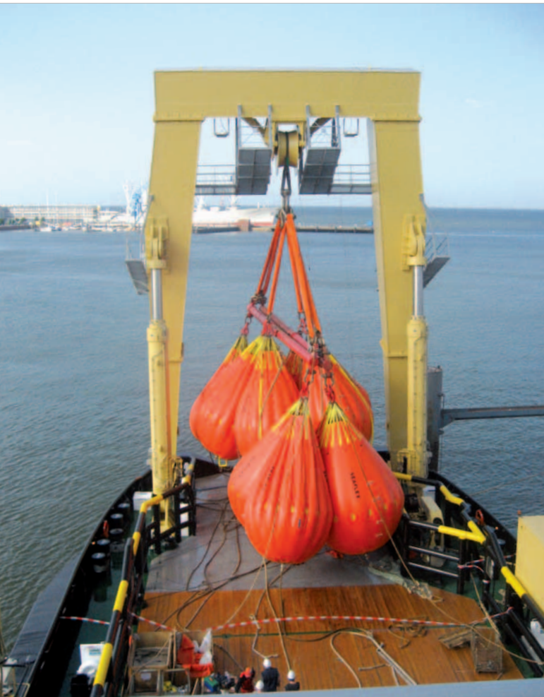
In der Topposition des A-Frame wird eine „Hakenhöhe“ von maximal 14,70 m erreicht
