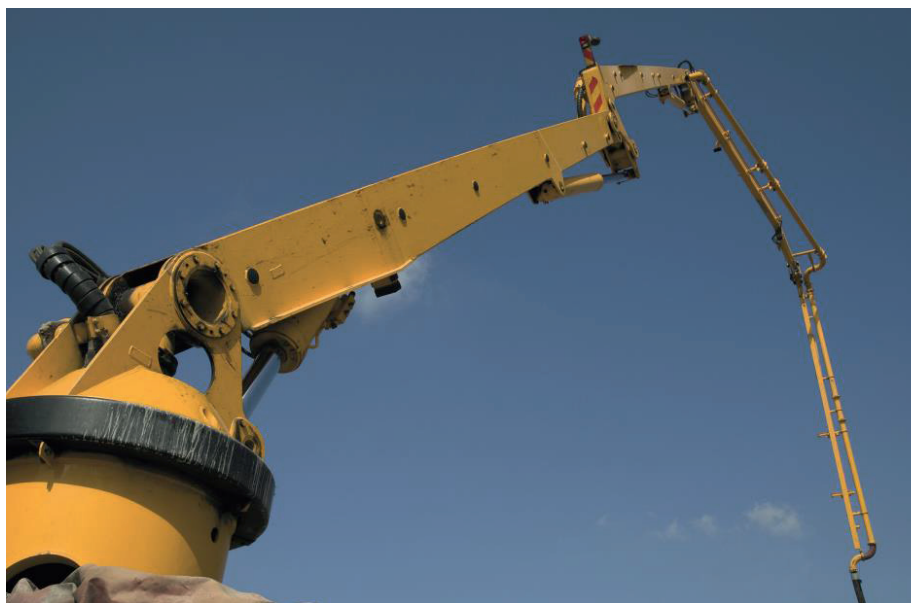
Bei Arbeitsdrücken bis zu 400 bar überwachen hochdruckfeste Sensoren die exakten Endstellungen der Hydraulikkolben im Zylinder
