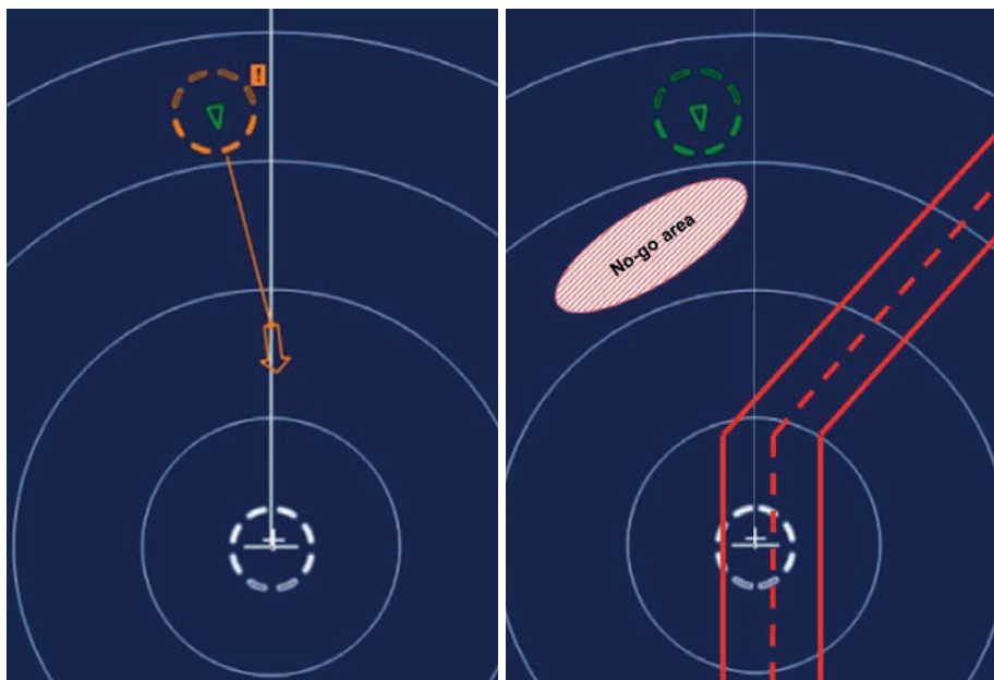
Abb. 2: Die Critical Ship Pose (CSP) zeigt die Pose der dichtesten Annäherung auf Basis von Positionsgenauigkeit, Kursschwankung und Geschwindigkeitsschwankung (links). Die CSP wird aufgrund von No-go Areas und/oder der Route unterdrückt. Es wird kein Alarm ausgelöst (rechts).
