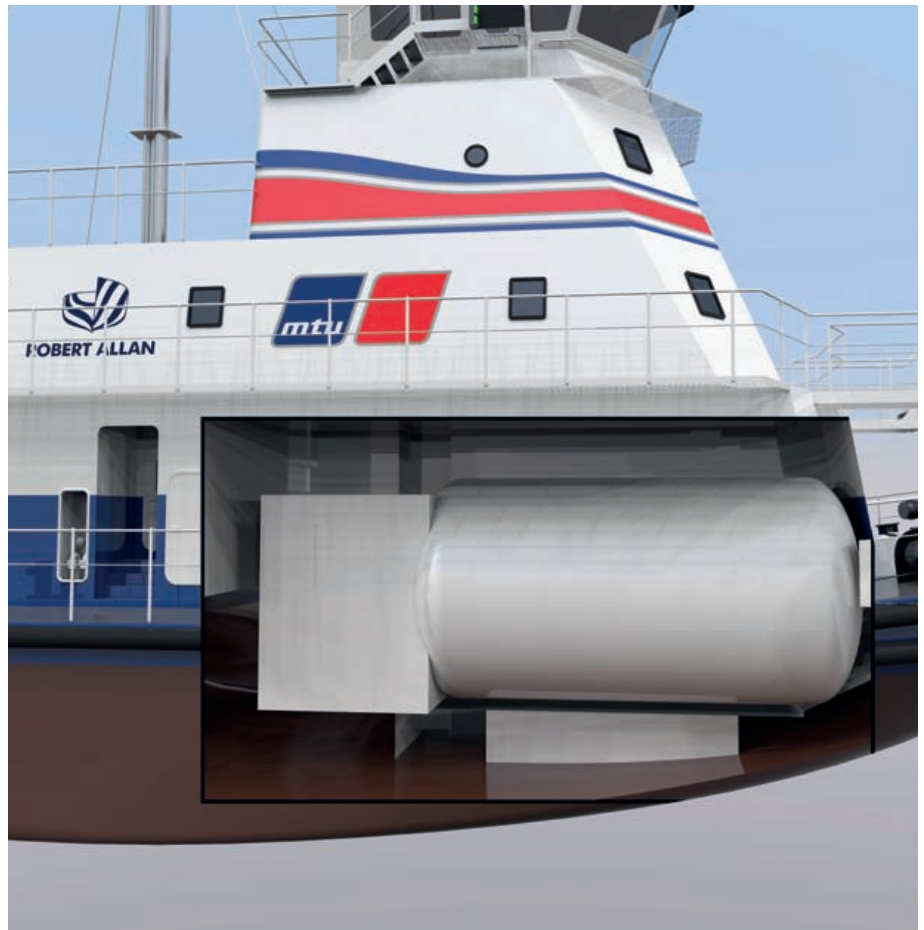
Anordnung des 70 m 3 fassenden Gastanks
