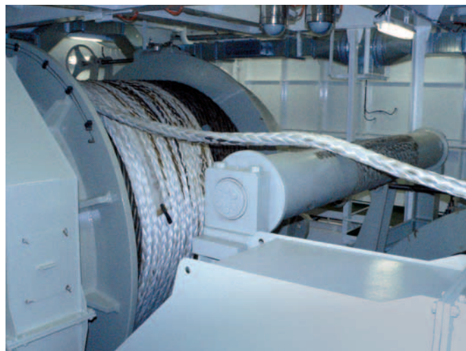
Die HATLAPA-Hauptwinde weist eine Haltekraft von 5000 kN auf
