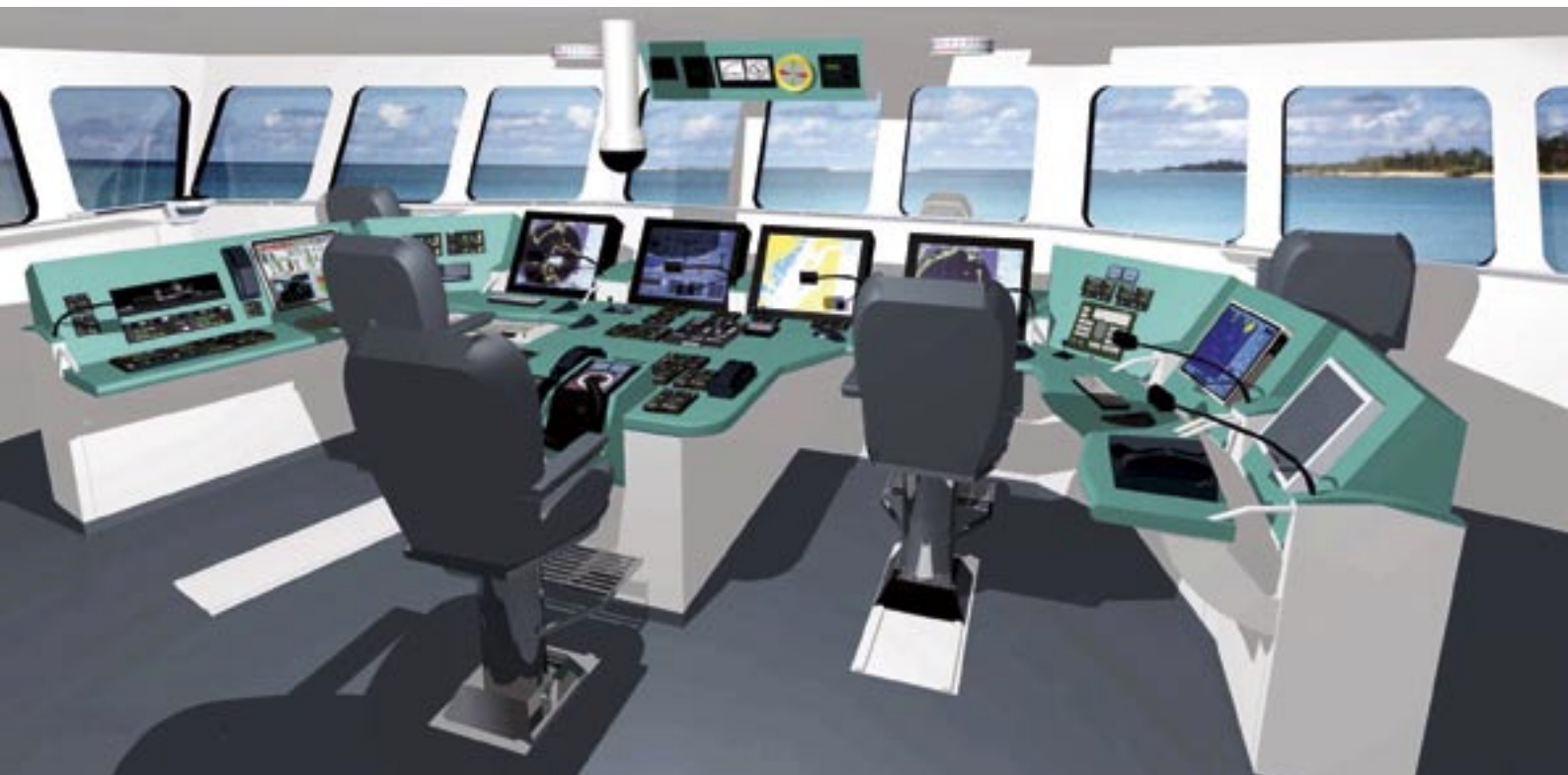
Grafische Ansicht der integrierten Brücke
