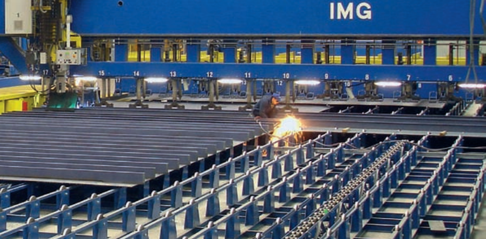
Profilaufsetz- und Schweißstation auf der italienischen Werft Fincantieri in Monfalcone
