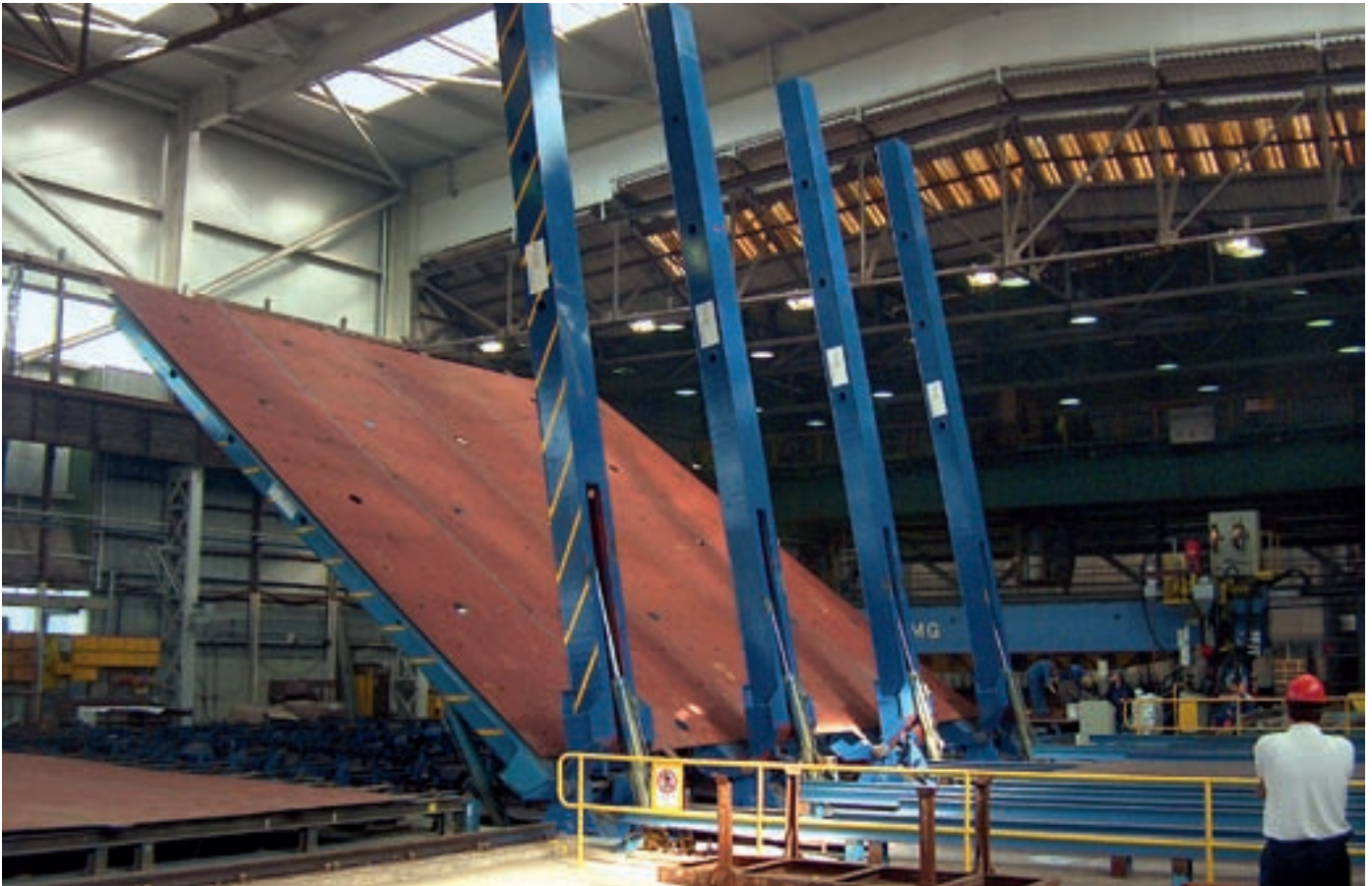
Wendeeinrichtung für Paneellinie für die Werft ULJANIK im kroatischen Pula
