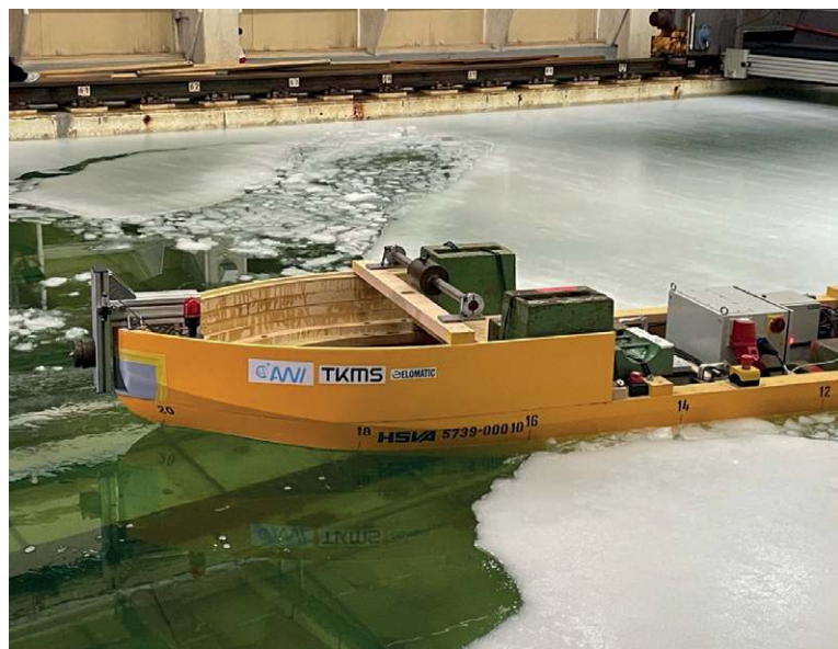
Das Modell der neuen „Polarstern“ während der Tests in der Hamburger Schiffbau-Versuchsanstalt
