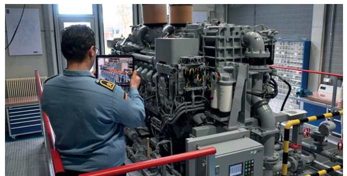
Kern des neuen Ausbildungskonzepts ist ein sogenanntes Kaltmodell des mtu-Motors 20V 4000 M53B, das seit März in der Marineteknikschule in Parow zur Verfügung steht Foto: BAAINBW
