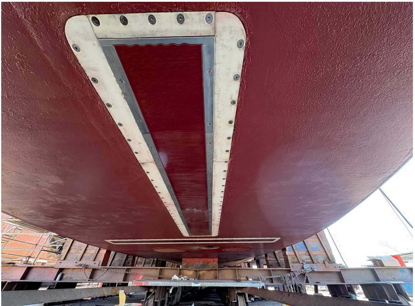
Das installierte Multibeam-Echolot EM 304 MKII am Rumpf des Forschungsschiffs „Nautilus“
