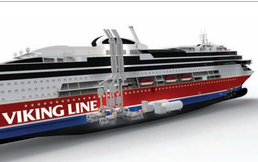
Anordnung der Motoren und Tanks an Bord Abbildung: Wärtsilä
