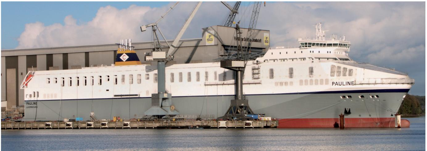
Mit einer Länge von 203 m und einer Breite von 31 m ist die ConRo-Fähre „Pauline“, die die FSG 2007 an die belgische Reederei Cobelfret N.V. abgeliefert hat, der bis dato größte Neubau der Werft
