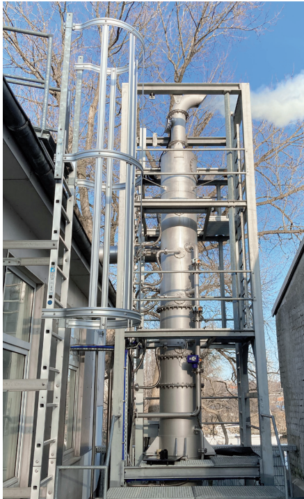
Abb.1: Closed-Loop-Scrubber an der Hochschule Flensburg während des Schwerölbetriebs
