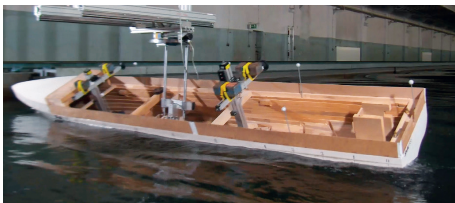
Abb. 2: Modell der RoPax-Fähre an der angepassten Nachführvorrichtung bei Rollmessungen
