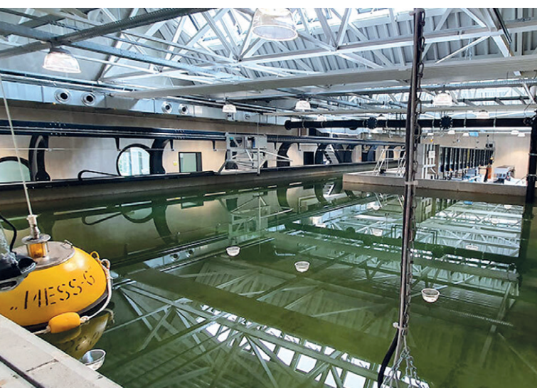
Im Maritimen Technikum der Hochschule Emden/Leer steht Forschenden unter anderem ein Schlepptank zur Verfügung, in dem Schiffsmodelle unter realitätsnahen Bedingungen getestet werden können
